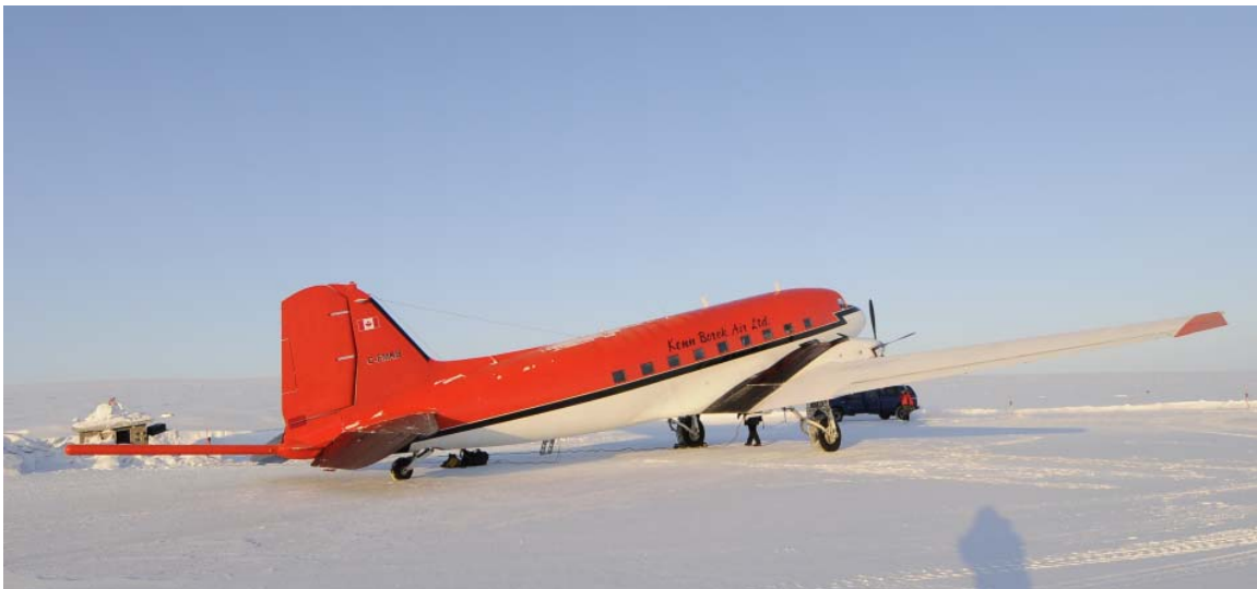
DC3'eren fra 1942, en stabil gammel maskine der er udstyret med moderne turbopropmotorer.
