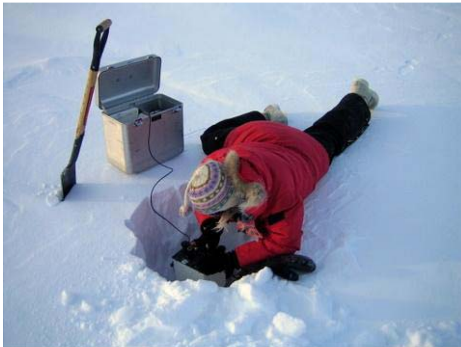
Henriette Skourup fra DTU-Space måler jordens tyngdefelt ved hjælp af et gravimeter
